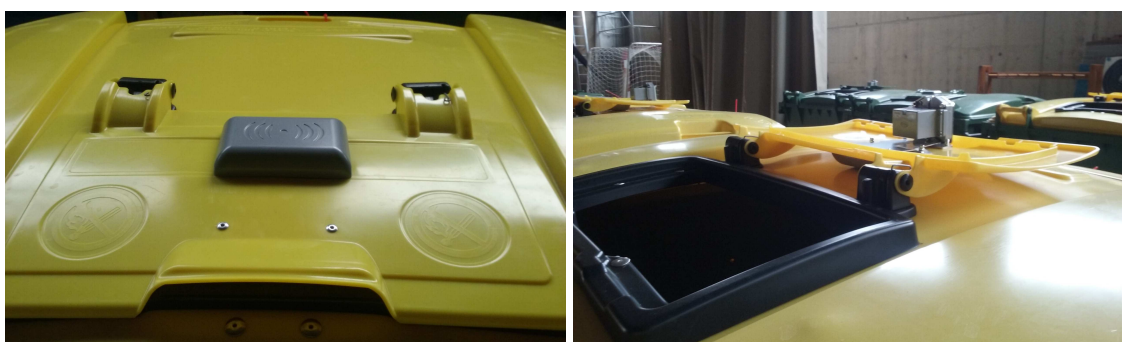
Detalls del lector de targes i el dispositiu d'obertura de la tapa del contenidor
